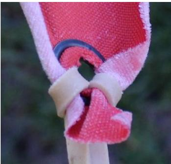
绑上橡胶条在每个预留在帆布上的洞。
